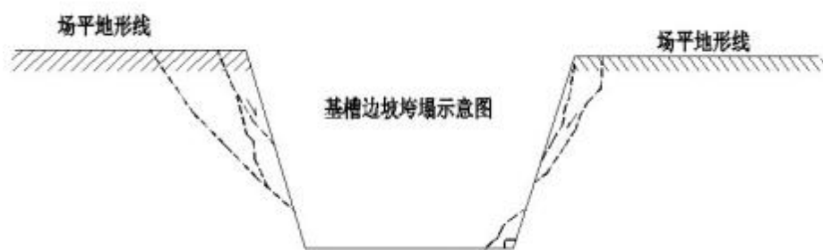
图 4.1-3 基坑（槽）边坡垮塌示意图
